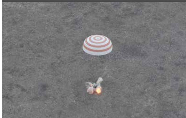
↑ Trois heures après le désamarrage, un système de parachutes se déploie selon une séquence précise. La capsule de rentrée entame une descente stable à une vitesse d'environ 7 m/s. (NASA)
