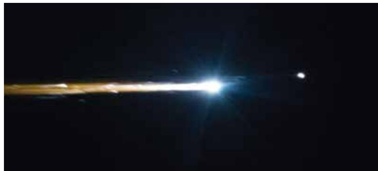
↑ Lors du retour sur Terre, les modules du Soyouz se séparent avant la rentrée dans l'atmosphère, à environ 140 km d'altitude. Le module orbital et le module de service se désintègrent et se consomment dans l'atmosphère. (ESA/NASA)
